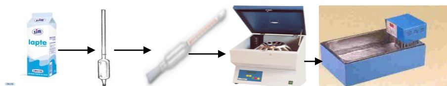
Fig. 8.7. Metoda acido – butirometrică (Gerber)
