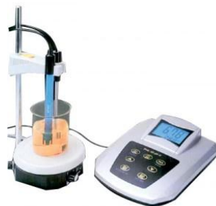
Fig. 8.5. pH-metru de laborator
