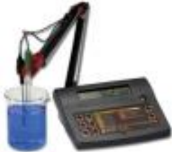
Fig. 10.2. pH-metru staționar Fig. 10.3. pH-metru portabil Hârtie și benzi indicatoare pH
