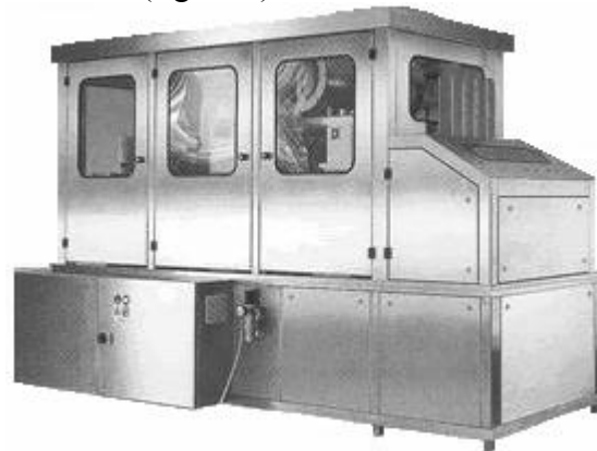
Fig. 7.8. Imaginea unei mașini de ambalare liniare în ambalaje termoformate preconfeționate
