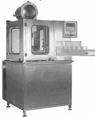
Fig. 7.7. Mașină de ambalare rotativă în ambalaje termoformate preconfeționate
